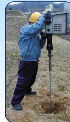
スラストパイプ上端に打ち込み工具をセットし、打ち込みを開始します。
